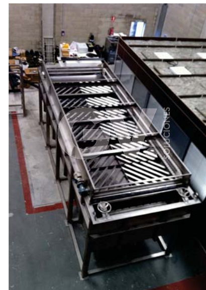
Equipo de flotación por aire disuelto en taller, el diseño del equipo podría variar en función de su caudal. DAF system in our workshop, the design may vary depending on the flow volume.
