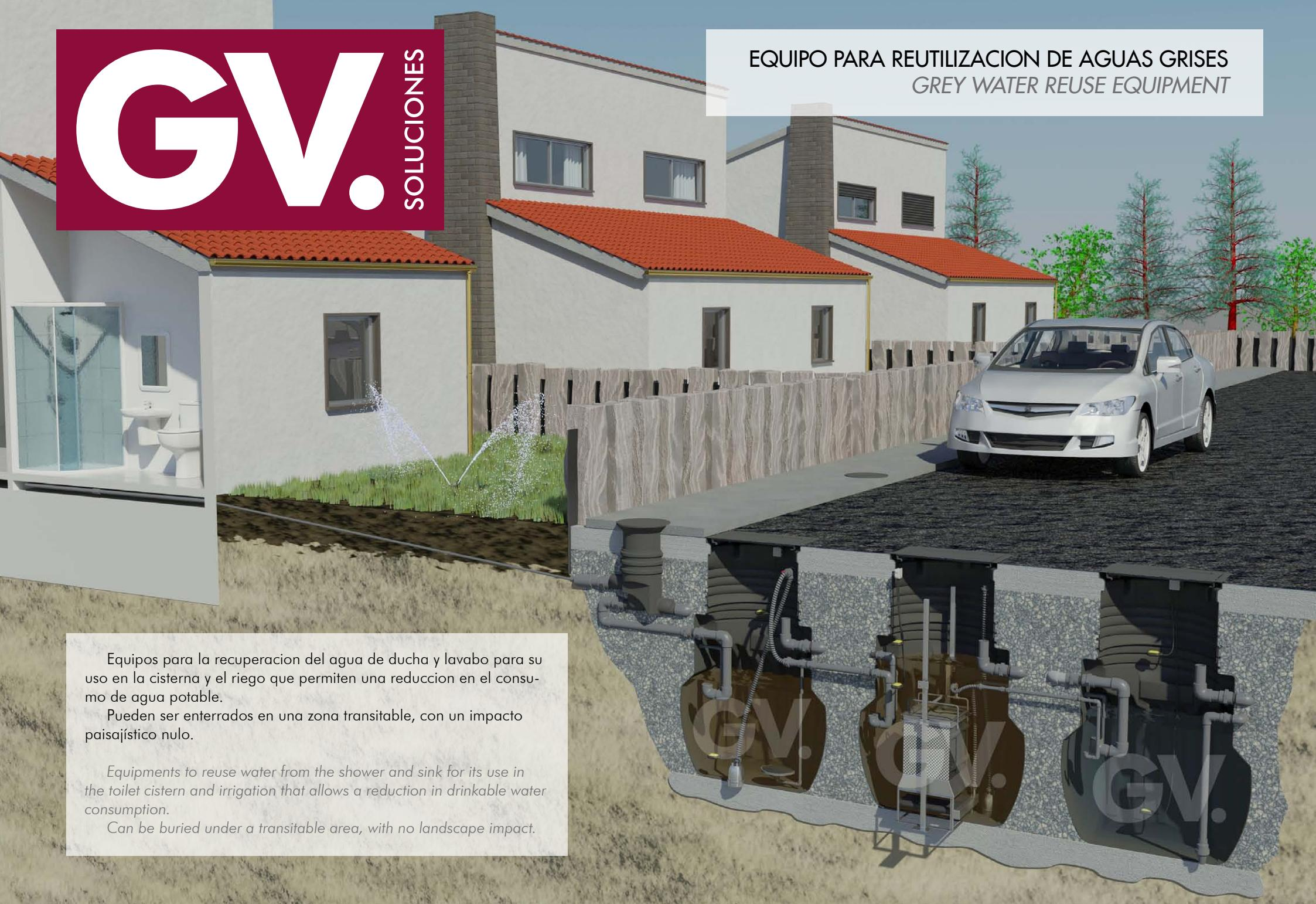
Equipos para la recuperacion del agua de ducha y lavabo para su uso en la cisterna y el riego que permiten una reduccion en el consumo de agua potable.
